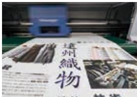
データをもとに染料を吹き付けてプリントする。データから直接捺染でき、環境負荷が少ないが、コストが高く小ロット向き。
