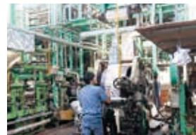
柄が彫刻された金属製のローラー型の凹部に捺染糊を含ませ回転させて捺染される。高速で捺染が可能だが、熟練の技術が必要。
