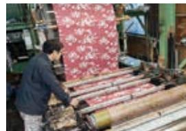
円筒状の型が回転し、その中から捺染糊がスキージロールによって押し出され捺染される。スピードが速く、連続柄に向く。
